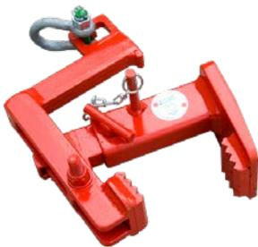
**Universalklemme:** zum Versetzen der Passelemente mit dem Minikran. Universalklemme PK175 für Passelemente Wandstärke 100 mm bis einschl. 175 mm und Universalklemme PK300 für dickere Wände. Diese Klemmen werden von Calduran vermietet oder verkauft.
