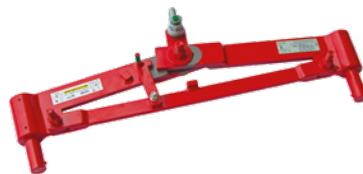
**Scherenklemme:** zum Versetzen einzelner Standardelemente mit dem Minikran. Planelemente bis einschließlich Wandstärke 240 mm haben Lochabstand 500 mm und können mit der Elementeklemme EK500 gehoben werden. Planelemente in Wandstärke 300 mm und Hochleistungs-Planelemente 240, 250 und 300 mm haben Lochabstand 600 mm und können mit der Elementeklemme EK600 gehoben werden. Diese Klemmen werden von Calduran vermietet oder verkauft.
