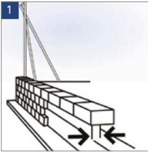
1 Kimmblöcke vollflächig unterfüttern. Zu kurze Decken sind zu verlängern. Stoßfugen der Kimmern vermörteln.
