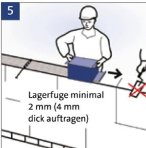
5 Lagerfuge minimal 2 mm (4 mm dick auftragen)
