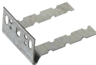
**Wandanker:** bei starren Wandanschlüssen und bei Anschlüssen mit vorgefertigtem Beton/Stahl/Holz/ Kalksandstein. Anker max. 650 mm Mittenabstand. Flexibel: bei verfüllten Dehnungsfugen / flexiblen Anschlüssen von ca. 10 mm an vorhandene Konstruktionen oder bei unterschiedlichen Schichtabmessungen, Mittenabstand max. 650 mm. Starr oder flexibel, sendzimirverzinkt, je 100 Stück.
