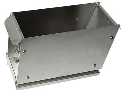
**Calduran-Mörtelkelle:** für jeden Wandstärke soll eine Mörtelkelle vorhanden sein, mit der der Stoßfugenmörtel gleichmäßig aufgetragen werden kann. Mörtelkellen werden von Calduran verkauft.
