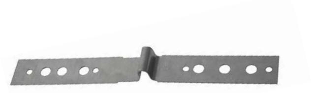
**Mauerverbinder beweglich:** bei verfüllten Dehnungsfugen von ca. 10 mm, Mittenabstand 650 mm. Sendzimirverzinkt, je 250 Stück.
