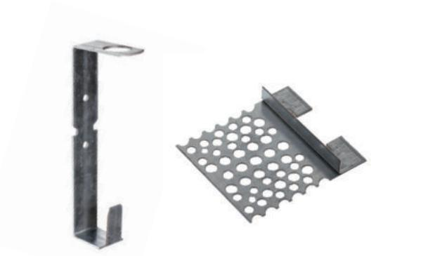
**Randsicherung:** Lochplatte in Mörtelfuge zwischen den oberen 2 Elementschichten befestigen, 1 Rohrhalter je Lochplatte. RB-Rohrhalter 370 sendzimirverzinkt, je Stück. RB-Rohrhalter, sendzimirverzinkt, je 50 Stück.
