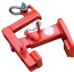
**Universalklemme:** zum Versetzen der Passelemente mit dem Minikran. Universalklemme PK175 für Passelemente Wandstärke 100 mm bis einschl. 175 mm und Universalklemme PK300 für dickere Wände. Diese Klemmen werden von Calduran vermietet oder verkauft.
