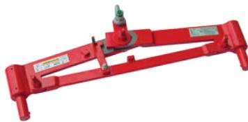
**Scherenklemme:** zum Versetzen einzelner Standardelemente mit dem Minikran. Planelemente bis einschließlich Wandstärke 240 mm haben Lochabstand 500 mm und können mit der Elementeklemme EK500 gehoben werden. Planelemente in Wandstärke 300 mm und Hochleistungs-Planelemente 240, 250 und 300 mm haben Lochabstand 600 mm und können mit der Elementeklemme EK600 gehoben werden. Diese Klemmen werden von Calduran vermietet oder verkauft.
