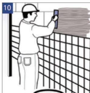
10 Fliesen können direkt auf das Kalksandstein-Planelement-Mauerwerk geklebt werden.
