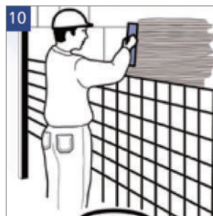
10 Fliesen können direkt auf das Kalksandstein-Planelement-Mauerwerk geklebt werden.
