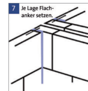
7 Je Lage Flachanker setzen. Anschluss Stabilitätswand mit tragende Wand, voll und satt verkleben.
