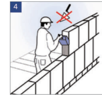
4 Empfehlenswert: Bei Pass- und Ergänzungselementen, Stoßfugen mit verleimen.
